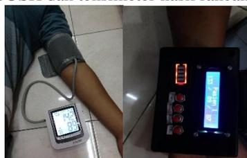
Gambar 8. Perbandingan Pengukuran Tensimeter GOSH dan Hasil Rancangan
