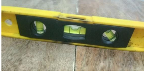
Gambar 33. Pengujian kesamaan tinggi dengan waterpass pada ketinggian 80cm
