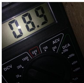
Gambar 25. Pengukuran tegangan setelah DC to DC step down
