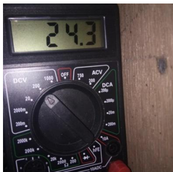
Gambar 24. Pengukuran tegangan keluaran power supply
