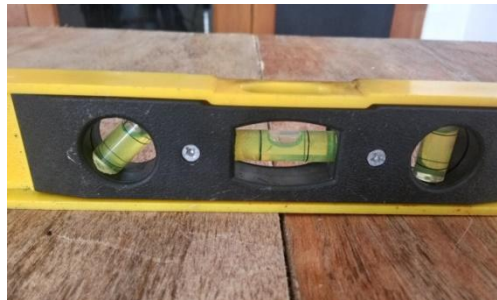
Gambar 34. Pengujian kesamaan tinggi dengan waterpass pada ketinggian 110cm
