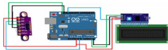
Gambar 3.3 Rangkaian Modul laser VL53LOXdengan Arduino Uno dan LCD
