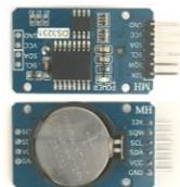
Gambar 5 Modul RTC DS3231 (*Real Time Clock*)
