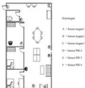
Gambar 2. Letak sensor magnet dan sensor PIR
