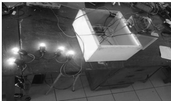
Gambar 18. Pengosongan Aki dengan Menggunakan Beban 25 watt
