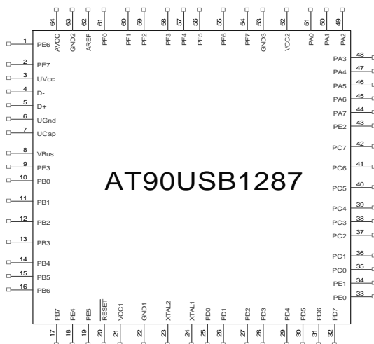
Gambar 2. Konfigurasi pin IC AT90USB1287
